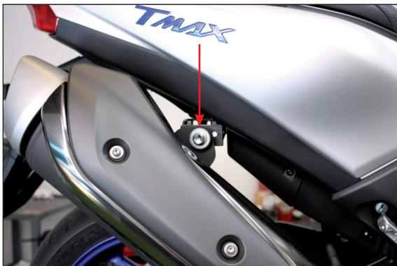
Svitare la vite indicata e rimuovere l'impianto di scarico originale
