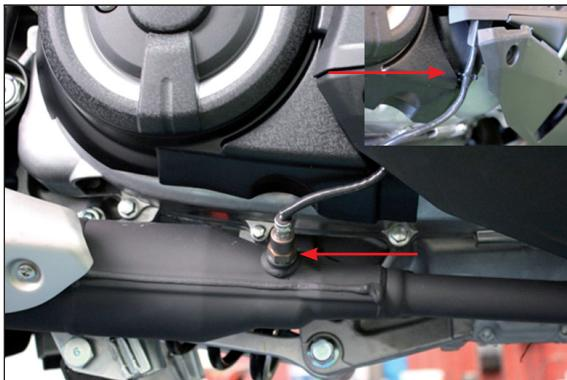
Tagliare la fascetta di fissaggio del cavo e svitare la sonda lambda
