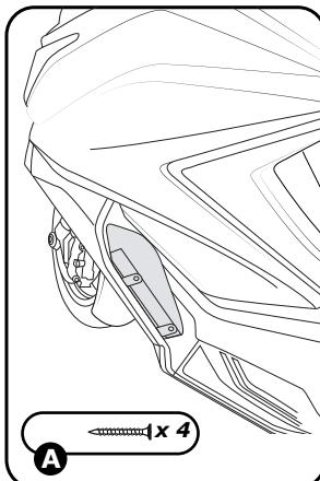
I Rimuovere le viti dello scooter nei punti 4. Montare su questi fori il profilo rigido usando le viti (A) fornite in dotazione.
