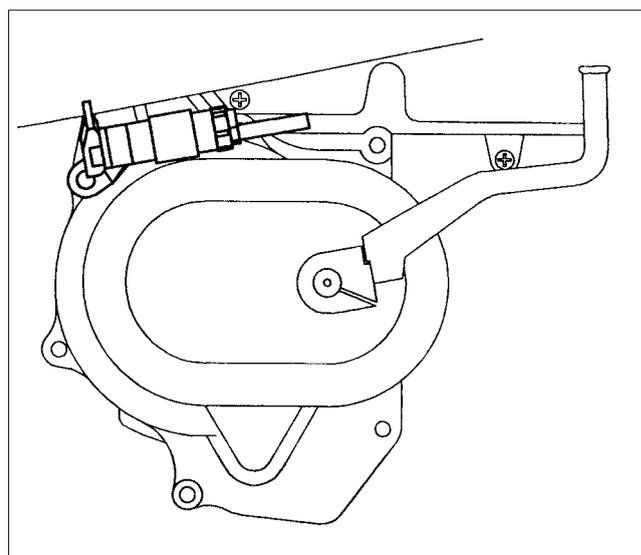
Collegare le relative trasmissioni di comando facendo una adeguata registrazione dei fili. Raccordare il tubetto del carburante al carburatore e il tubetto della lubrificazione al nuovo collettore, facendo attenzione che non vi siano trafileggi o impedimenti al passaggio dell'olio.
