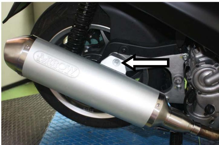
Innestare il terminale assemblato nel collettore originale e serrare senza stringere completamente l'attacco superiore
