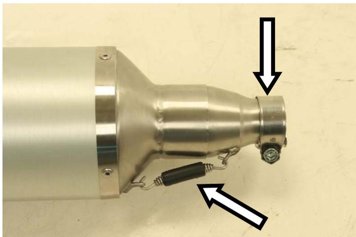
Innestare il collettore secondario nel terminale, ancorare la molla ed alloggiare la fascetta di serraggio
