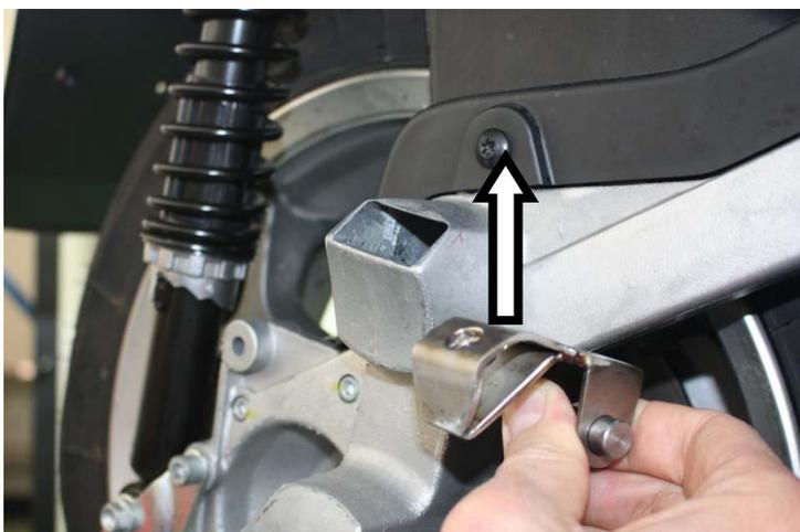
Inserire all'interno della piastra originale la staffa di fissaggio terminale con il dado rivolto verso l'alto
