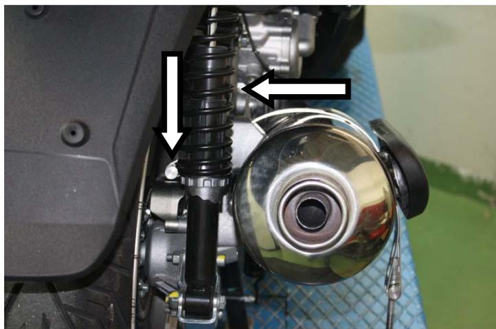
Arretrare verso l'interno della piastra di fissaggio terminale la fascetta e sfilare il perno
