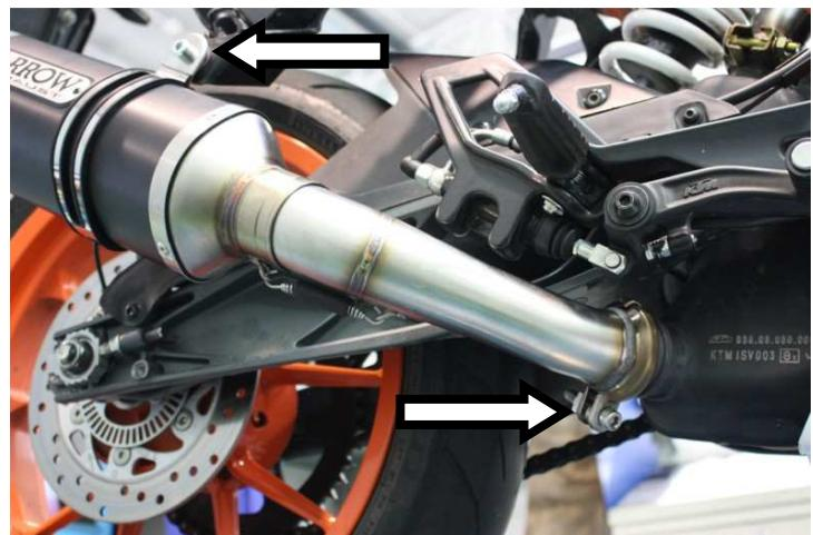
**IT** · Solo per terminali Thunder: Ancorare la molla, fissare il terminale alla staffa mediante fascetta di sostegno e serrare definitivamente la fascetta
