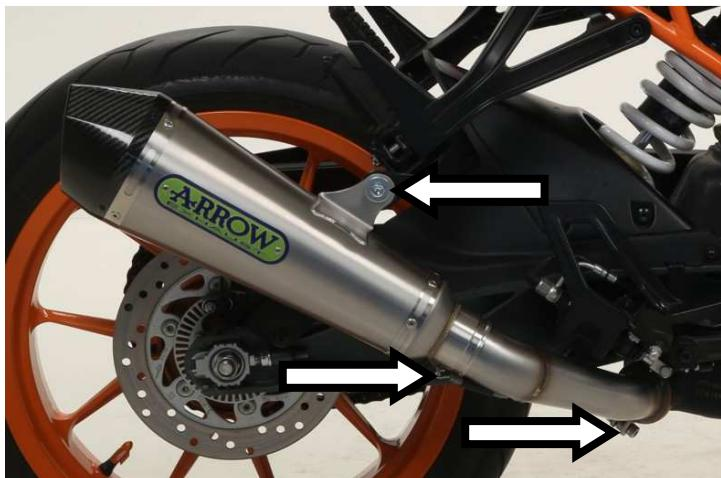
**IT** · Solo per terminali X-Kone: Fissare l'attacco alla staffa di sostegno, ancorare la molla e serrare definitivamente la fascetta
