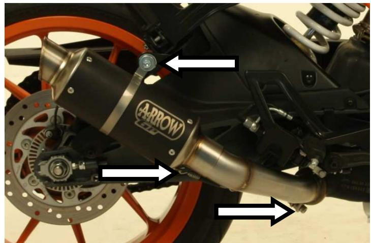
**IT** · Solo per terminali GP/GPI: Ancorare la molla, fissare il terminale alla staffa mediante fascetta di sostegno e serrare definitivamente la fascetta
