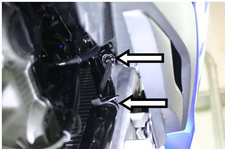
**IT** · Ricollegare il cavo della lambda e fissare il cavo al telaio mediante fascetta originale
