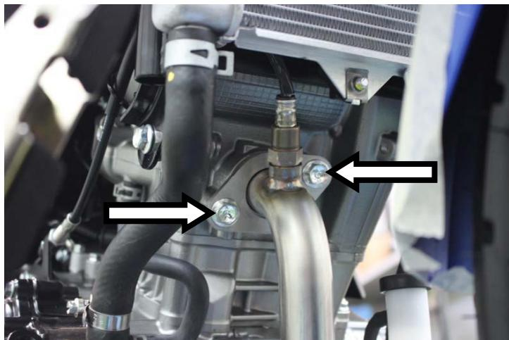
**IT** · Avvitare senza stringere completamente il collettore al cilindro
