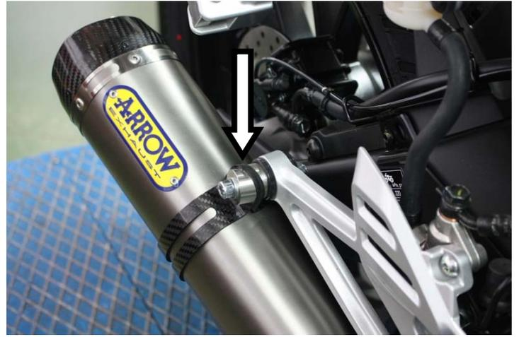
**IT** · Innestare il terminale Thunder e serrarlo alla pedana mediante fascetta (utilizzare nel lato interno della pedana la rondella originale)
