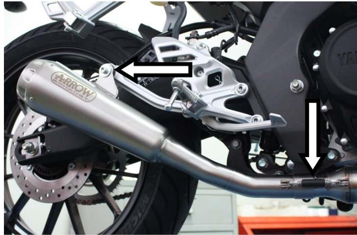
**IT** · Innestare il terminale Pro-Race, serrare l'attacco alla pedana ed ancorare la molla (utilizzare nel lato interno della pedana la rondella originale)
