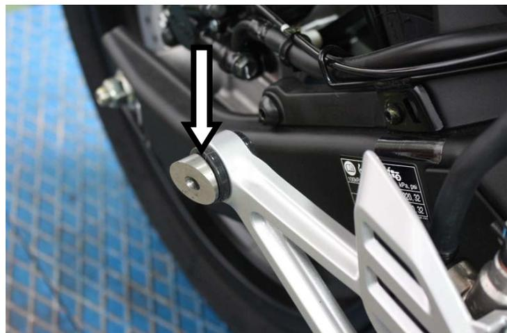
**IT** · Sostituire il bussolotto indicato con quello fornito
